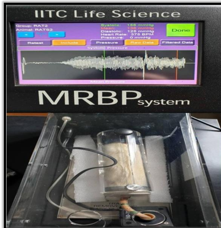
Слика 2. Апарат за одређивање вредности крвног притиска и срчане фреквенце код пацова.
